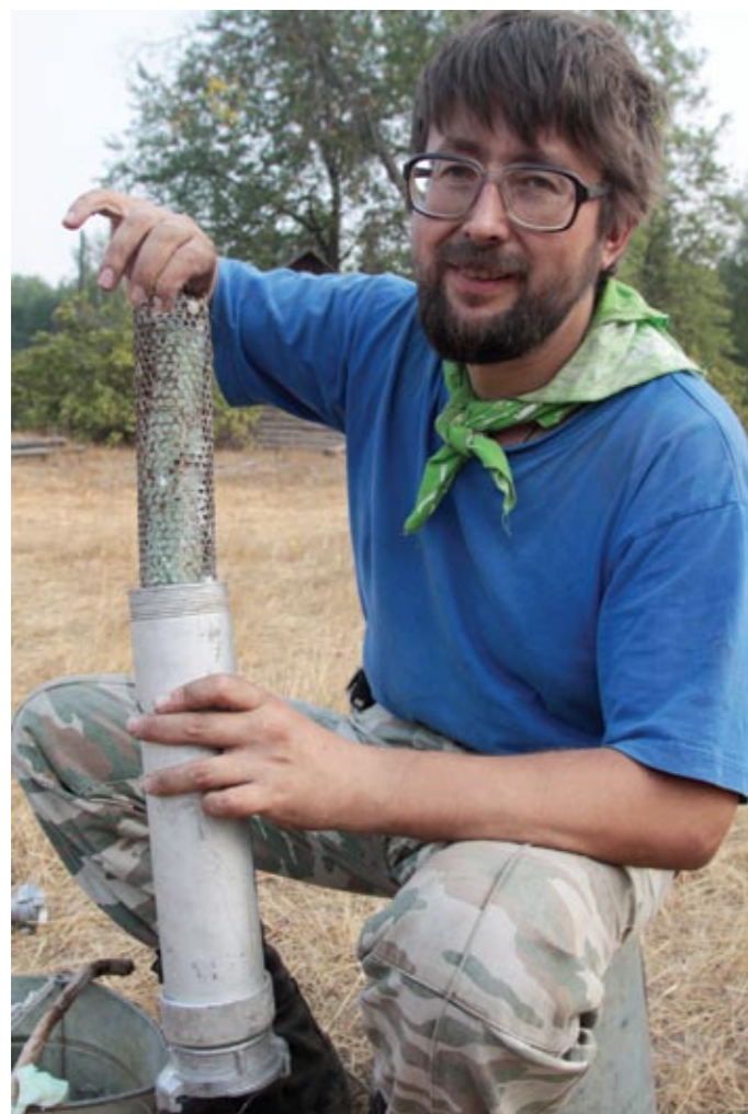
Использование специального смесителя для добавления смачивателя
